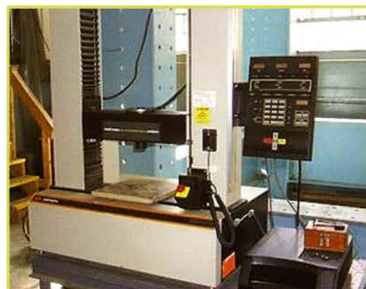
Fig. 7: la macchina dinamometrica INSTRON 4204 è un dinamometro elettromeccanico monoassiale interfacciato con una unità di calcolo, in grado di effettuare prove statiche di compressione, di tensione, flessione e taglio.
