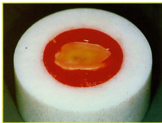
Fig. 2: i dischi dentinali vengono bloccati nei supporti in Teflon con una resina autoindurente a freddo.
