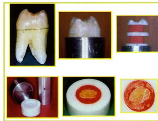
Fig. 3: fasi di allestimento dei campioni per i test meccanici: inglobamento e sezione dei campioni selezionati, supporti utilizzati per la fase di preparazione dei campioni, bloccaggio dei dischi dentinali nei supporti in Teflon.
